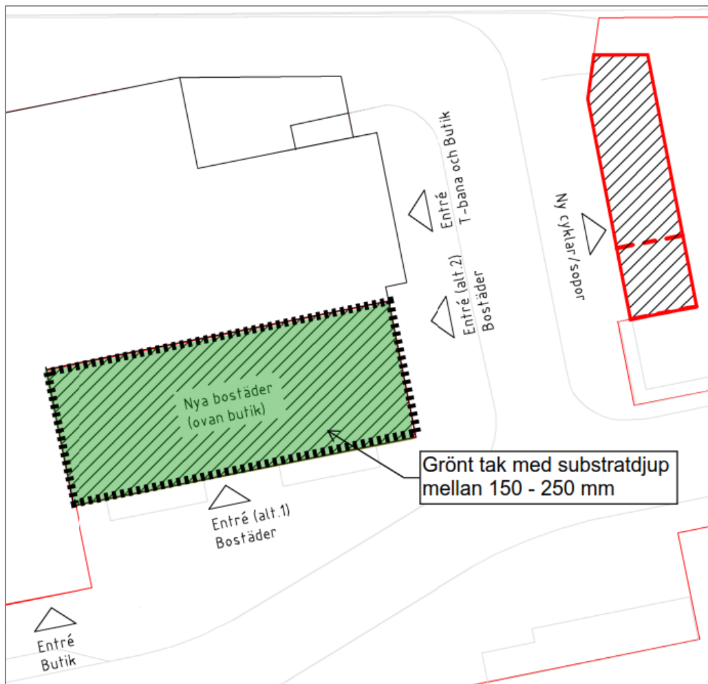
Figur 10. Åtgärder för dagvattenhantering för nybyggnadsytorna inom projektområde Traversen.
