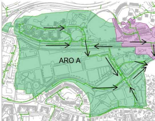
Figur 2-4. Tekniskt avrinningsområde (sammanfaller med ytligt avrinningsområde) till Kyrkviken via skärmbassängen där Tryckluftsfabriken ingår är markerat i grönt i vänstra bilden, "ARO A". Bilden inhämtade ur fördjupad VA-utredning (Sweco, 2018).
