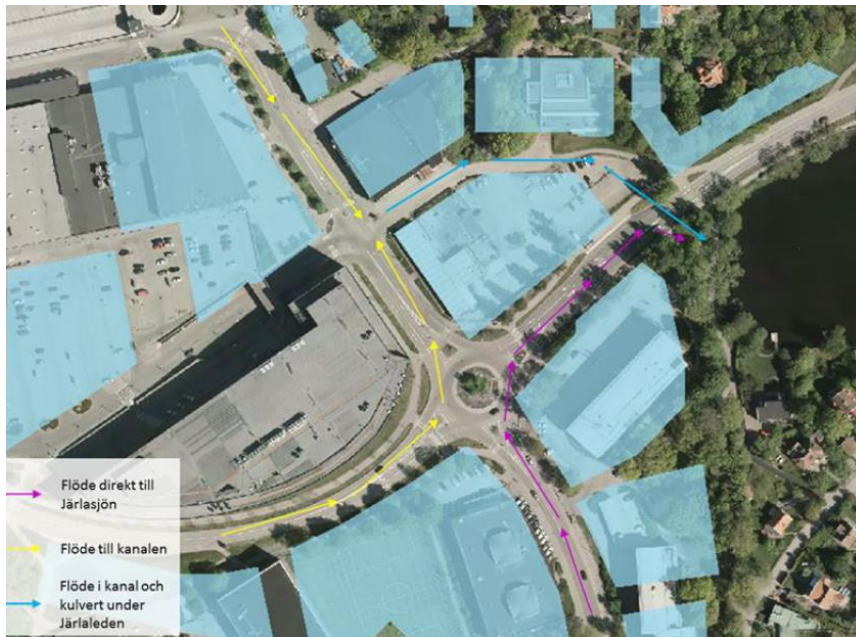
Figur 17. Planerad sekundär avledningsväg vid skyfall. Lågpunkten kommer förläggas vid Planiavägens korsning med Siroccogatans nuvarande läge för att möjliggöra avledning längs med Siroccogatans ut till Kyrkviken.
