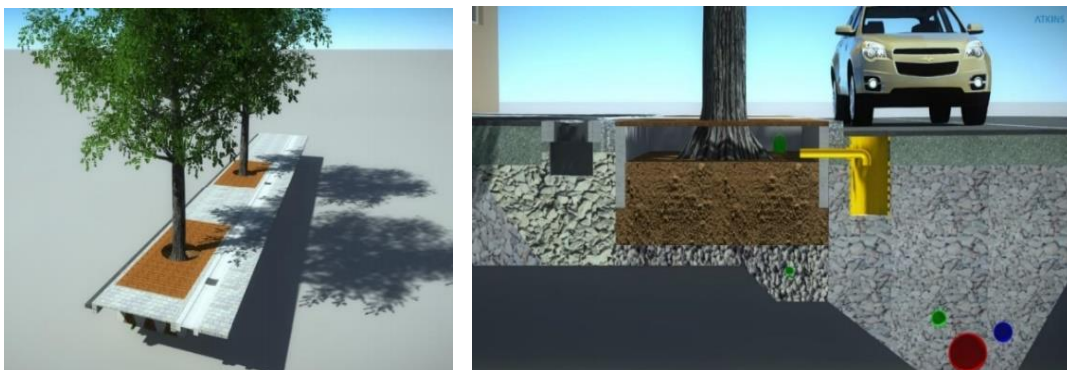
Figur 10. Princip för nedsänkt, övertäckt växtbädd i gaturum. Intag sker via en inloppsbrunn som släpper dagvatten ovan växtbäddssubstratet. För täta växtbäddar anläggs tätskikt och dräneringsledning som ansluter till dagvattenledning i gata (bilder inhämtade ur Nacka kommuns anvisningar för dagvattenhantering (Nacka Kommun, 2018).
