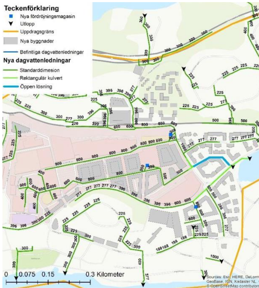
Figur 3. Urklipp ur projekterat förslag från Fördjupad VA-utredning och förprojektering av VA-nätet i delar av Nacka stad (Sweco, 2017). Ledningsstråk, dimensioner och magasin är synliga i bilden.
