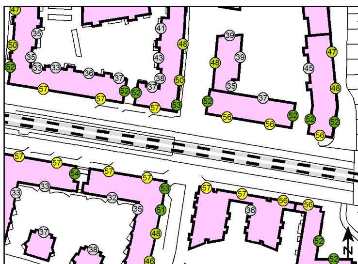
Bild 9. Redovisning av den högsta ekvivalenta ljudnivån som förekommer vid fasad för alla våningshöjder (numeriskt värde i cirkeln motsvarar frifältsvärdet). Tvärbanans hastighet 30 km/h.
