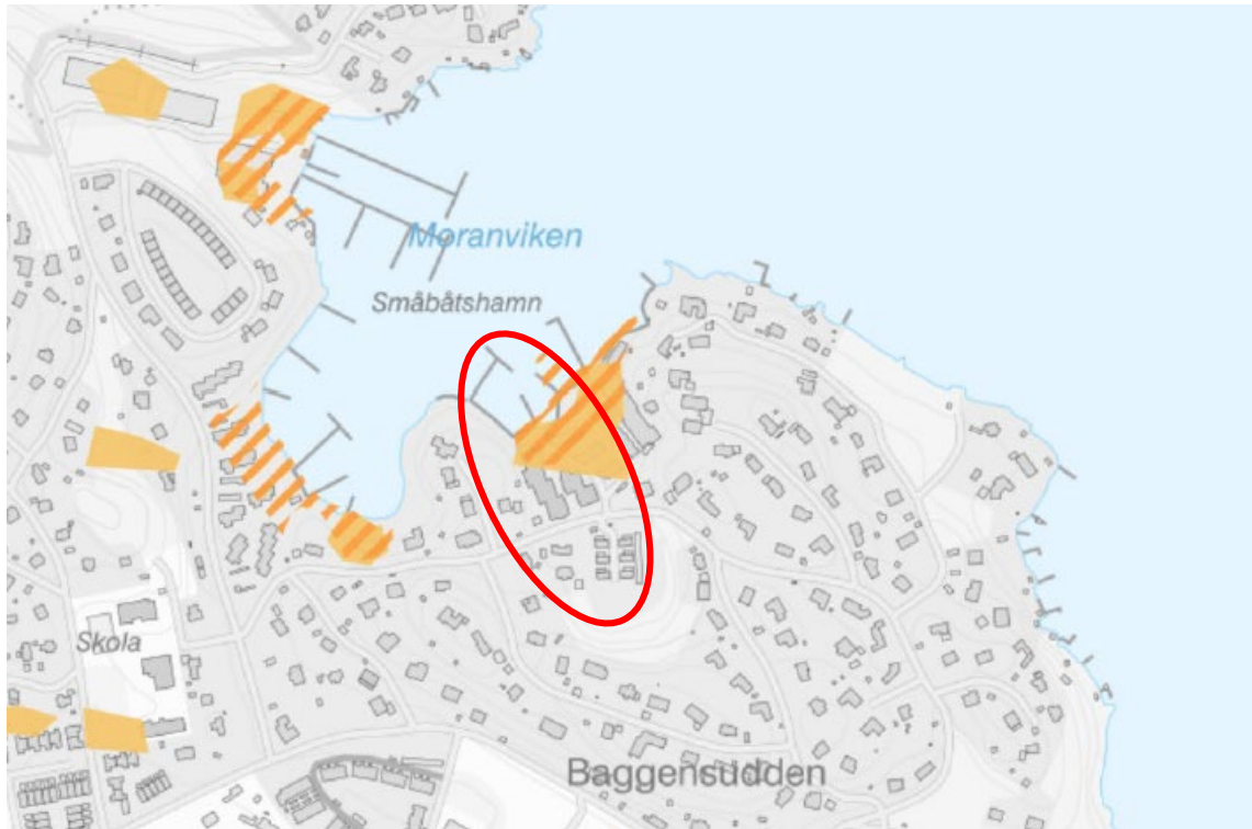
Figur 8. Förutsättningar för skred i finkornig jordarter - Sveriges geologiska undersökning (SGU). Orange beltäckande; Förutsättningar för skred i finkornig jordart – lutningsanalys. Orange randigt; Förutsättningar för skred i finkornig jordart - strandnära områden. Röd cirkel visar planområdets ungefärliga placering.
