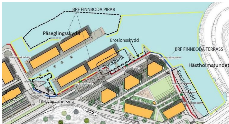
Figur 6. Schematisk bild över påseglingsskyddet, tryckbanken, den tillfälliga arbetsytan samt erosionsskyddens placering. Bedömd utbredning av förorenade sediment är inringat med gult sträck och sträcker sig utanför plangränsen. Källa: PM-Miljöföreningar (Nacka kommun, 2024-02-02)
