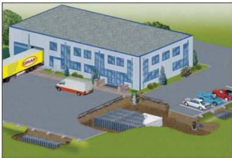
Figur 7. Skiss för anläggning av fördröjningsmagasin med dagvattenkassetter.
