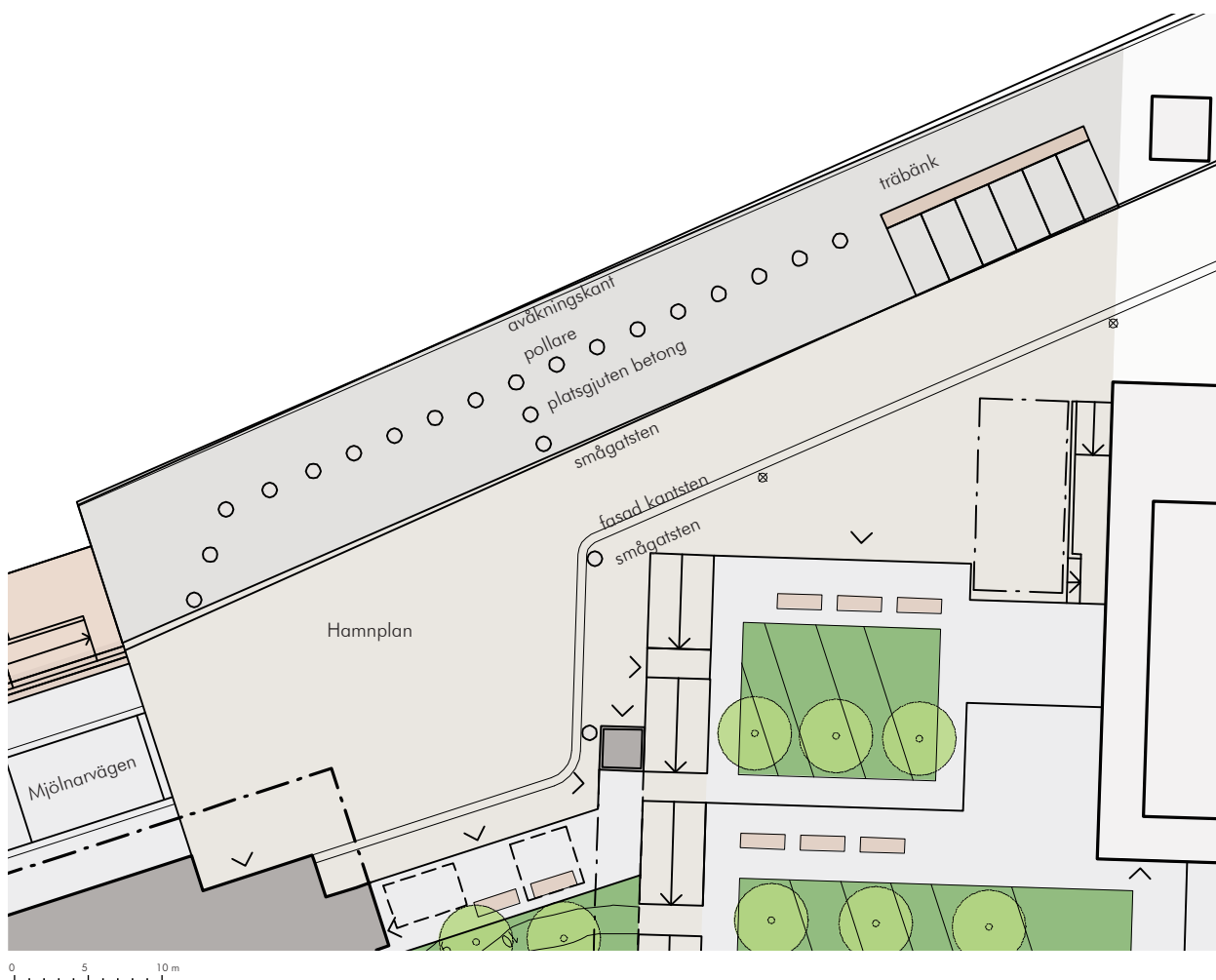
Illustration: Hamnplans utformning är lika övriga kajplanet med en stensatt inre del och en yttre betongkaj.
