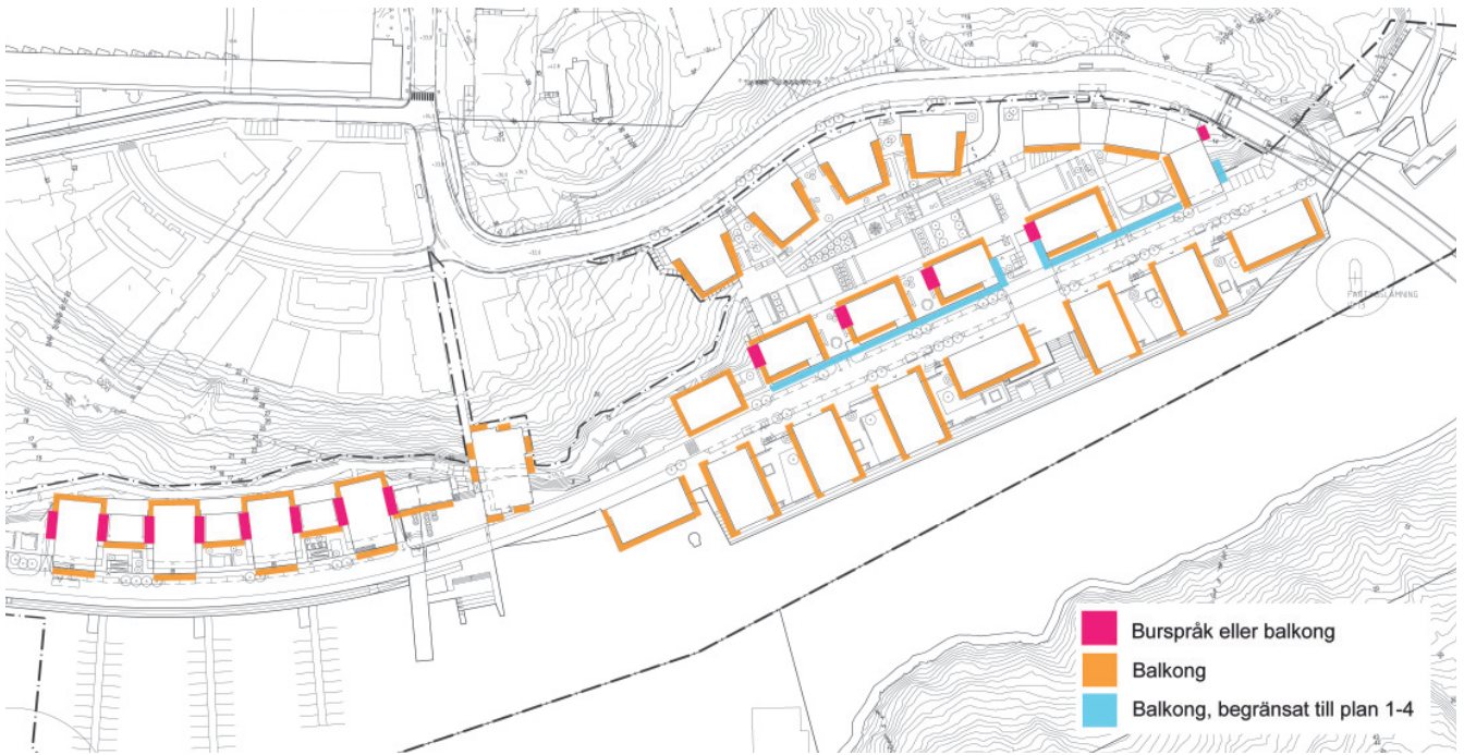
Placering av utkragande burspråk och balkonger
