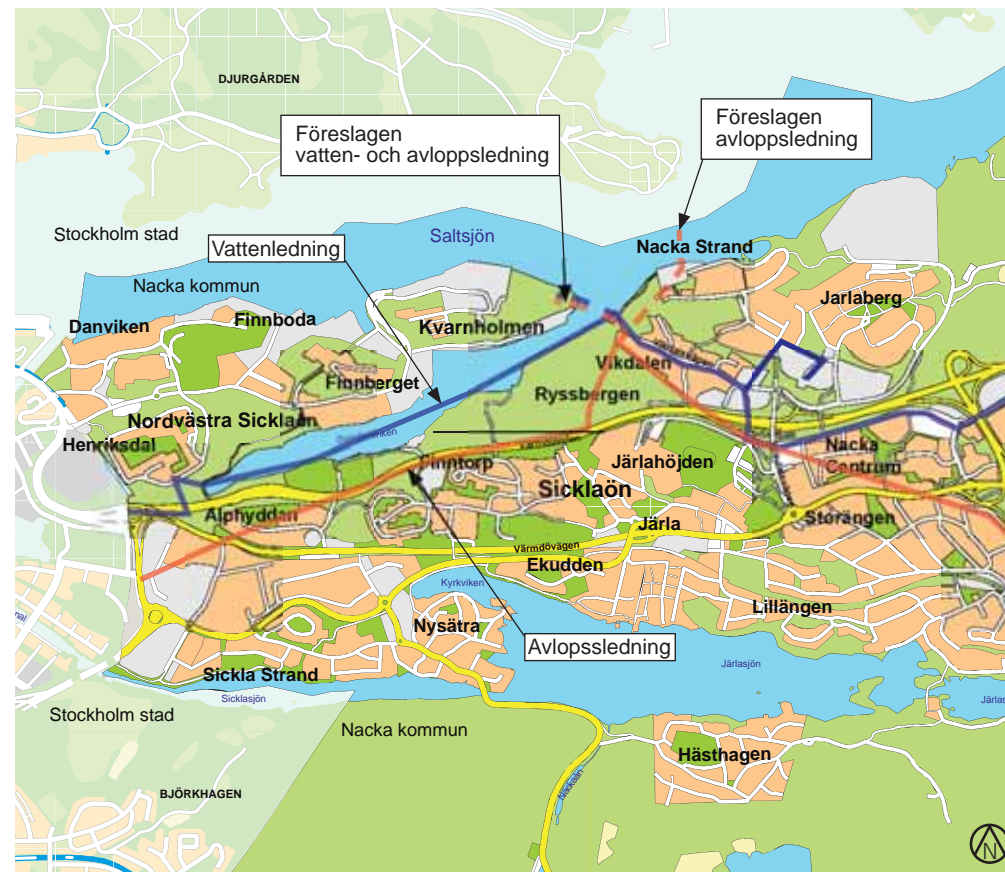
Figur 21. Vatten- och avloppsledningar.
