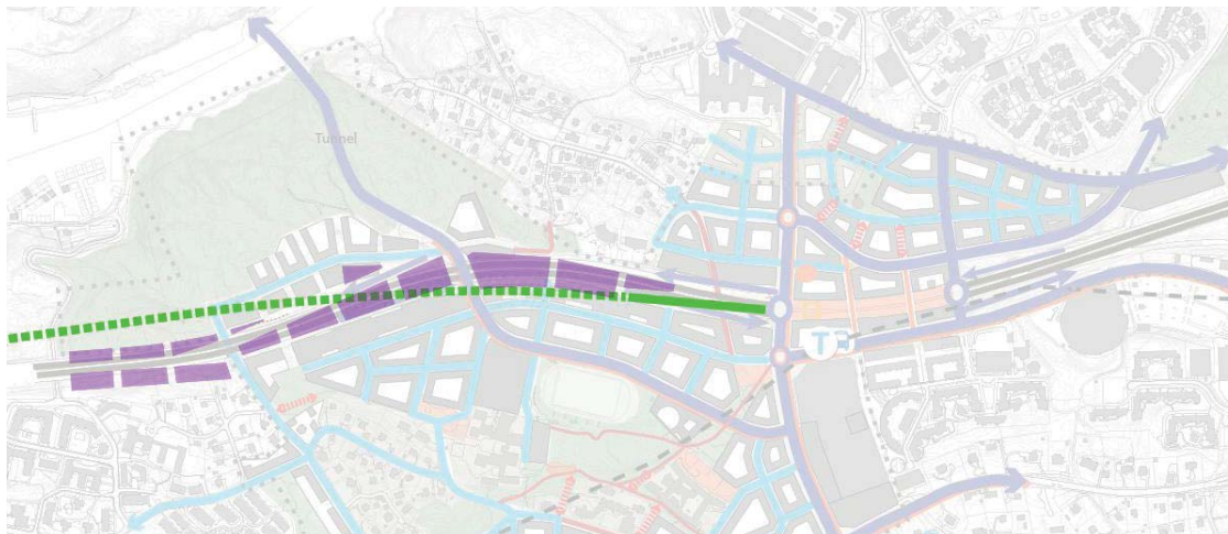
Tunnel till Nacka trafikplats. Tunneln markeras med grönt. Lila områden är områden med eventuell tillkommande bebyggelse och lokalgata.
