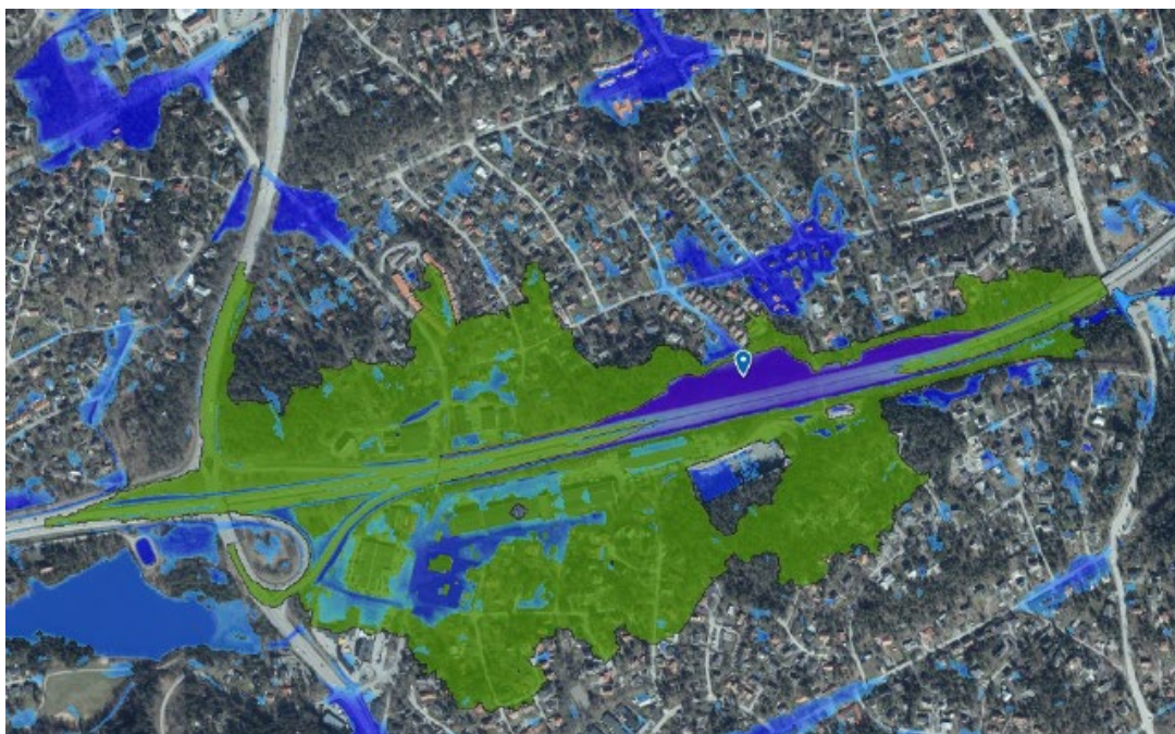
Figur 25. Kartan visar lågpunkt på Värmdöleden (markerad med kartnål) och lågpunktens tillrinningsområde i grönt. Bild: Scalgo Live
