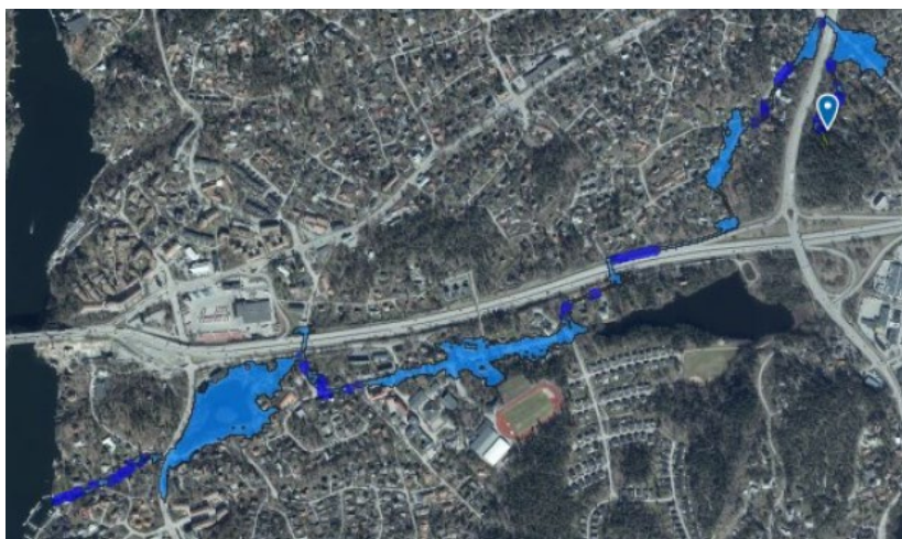
Figur 23. Kartan visar sekundär avrinning från den nordöstra delen av planområdet. Bild: Scalgo Live
