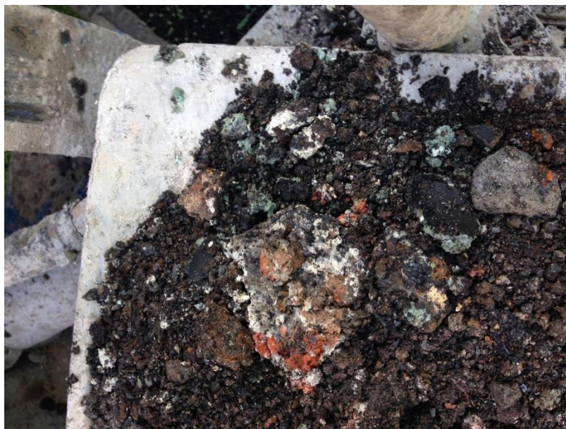
Figur 5. Fyllnadsmaterial i BH24 med inslag av byggavfall och grönt material mellan 0,5-2,0 m.u.my.
