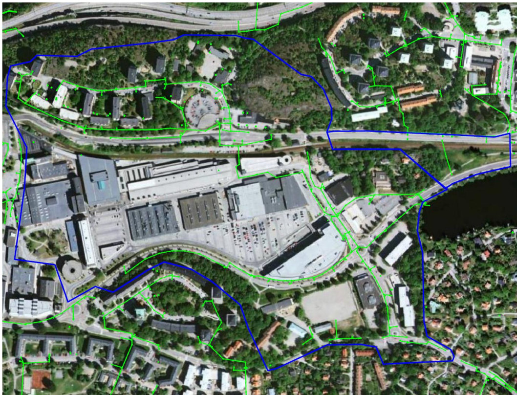
Figur 1. Avrinningsområdet (markerat med blått) och befintliga dagvattenledningar (markerade med grönt). Till höger kan recipienten Kyrkviken, en del av Järlasjön, ses.
