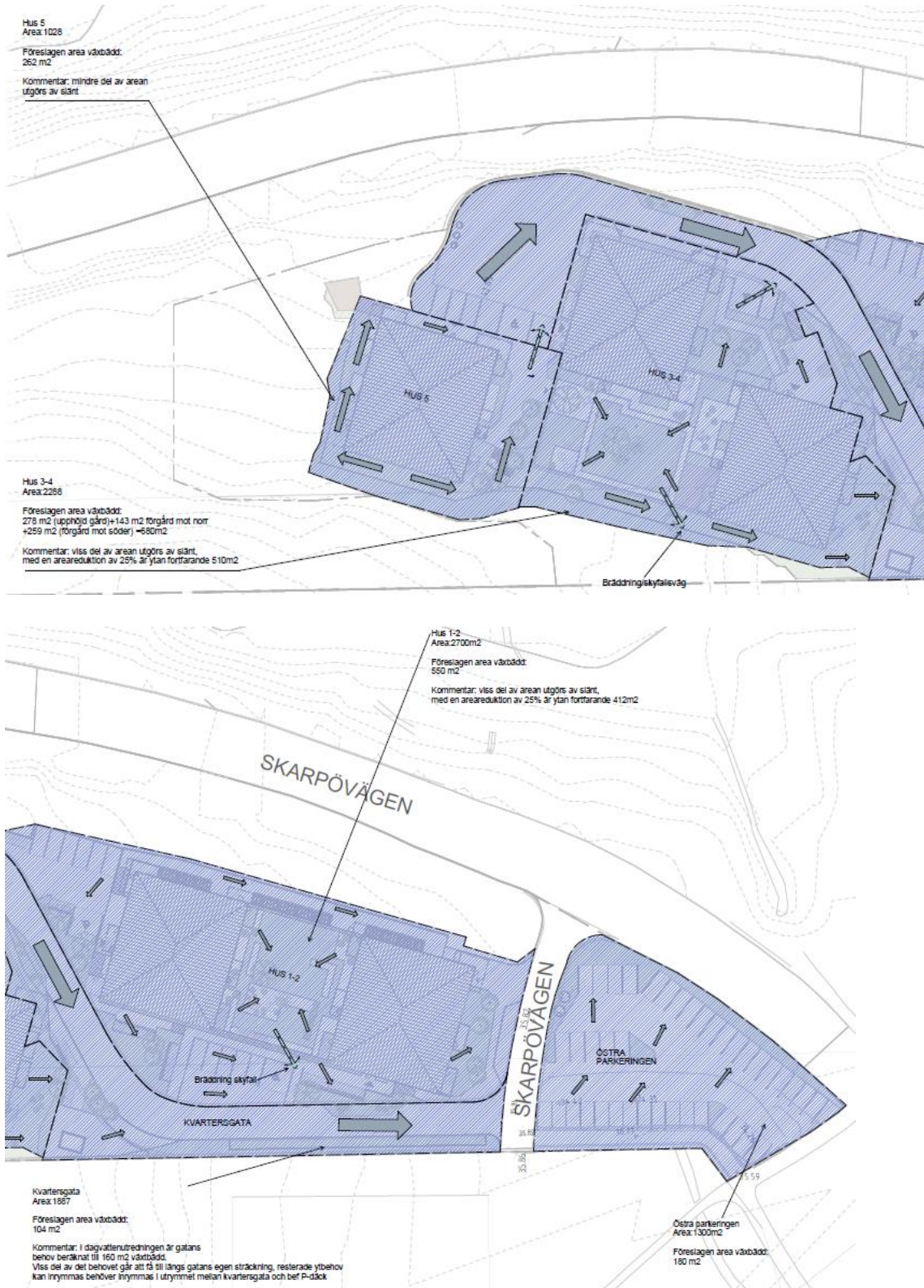
Fig 16 Illustrationen visar hur dagvatten är planerat att hanteras inom planområdet i växtbäddar om totalt 1180 kvadratmeter. För att undvika sprängning genomförs en grundare växtbädd utbredd på större yta. (Arkitema 2024)
