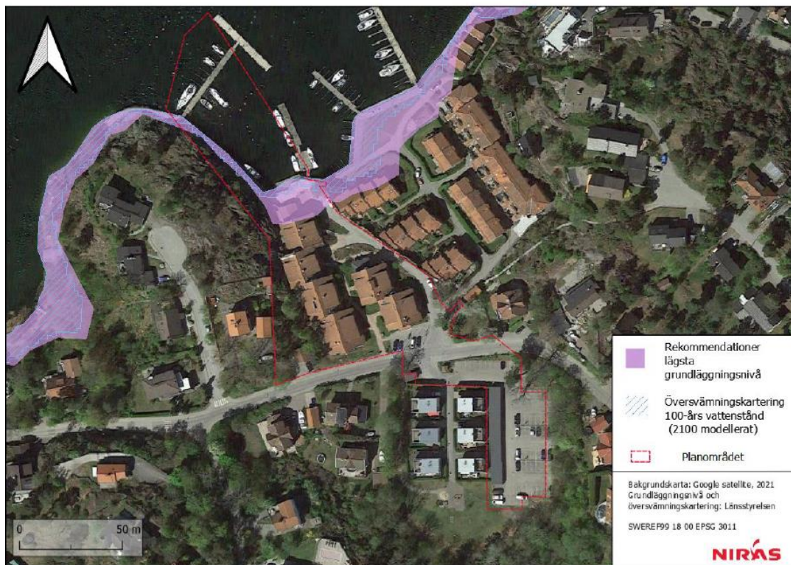
Figur 12. Lila områden ligger under rekommenderad lägsta grundläggningsnivå +2,7 meter RH2000 och framtida scenario för översvämning vid 100-års vattenstånd, (Niras, 2021).
