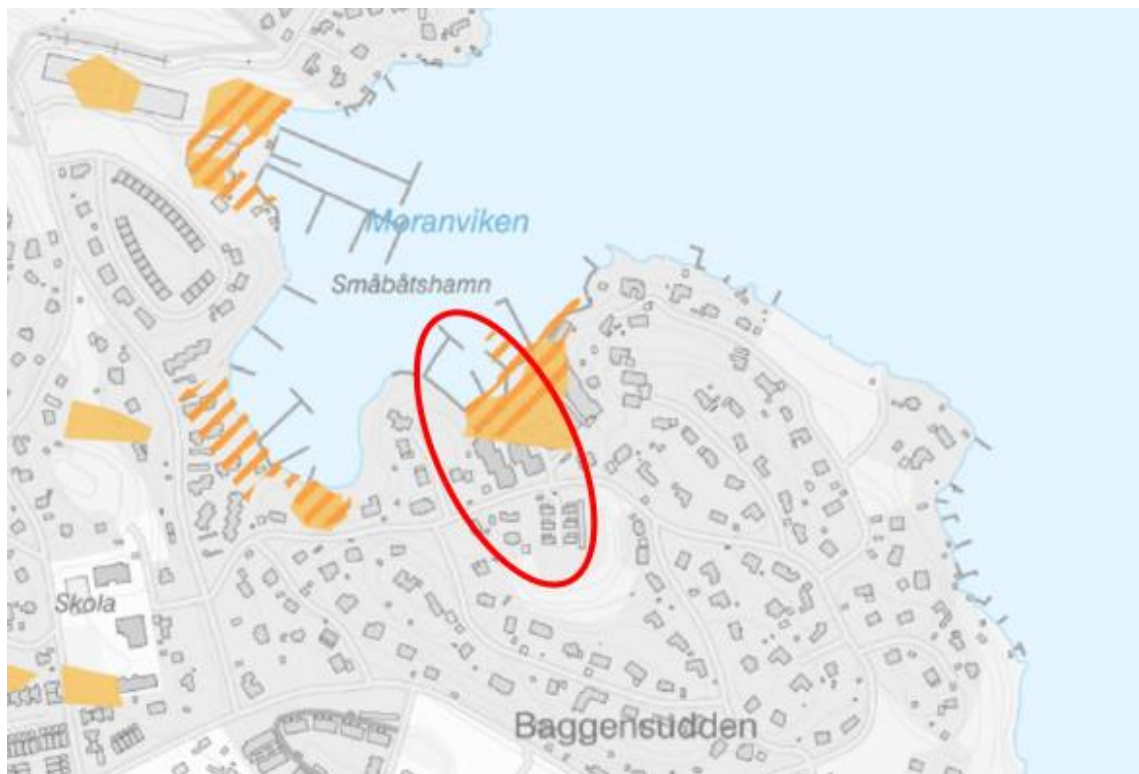
Figur 8. Förutsättningar för skred i finkorniga jordarter, från Sveriges geologiska undersökning (SGU). Orange heltäckande är förutsättningar för skred i finkornig jordart genom lutningsanalys. Orange randigt är förutsättningar för skred i finkornig jordart i strandnära områden. Röd cirkel visar planområdets ungefärliga placering, (Nacka kommun, 2025).
