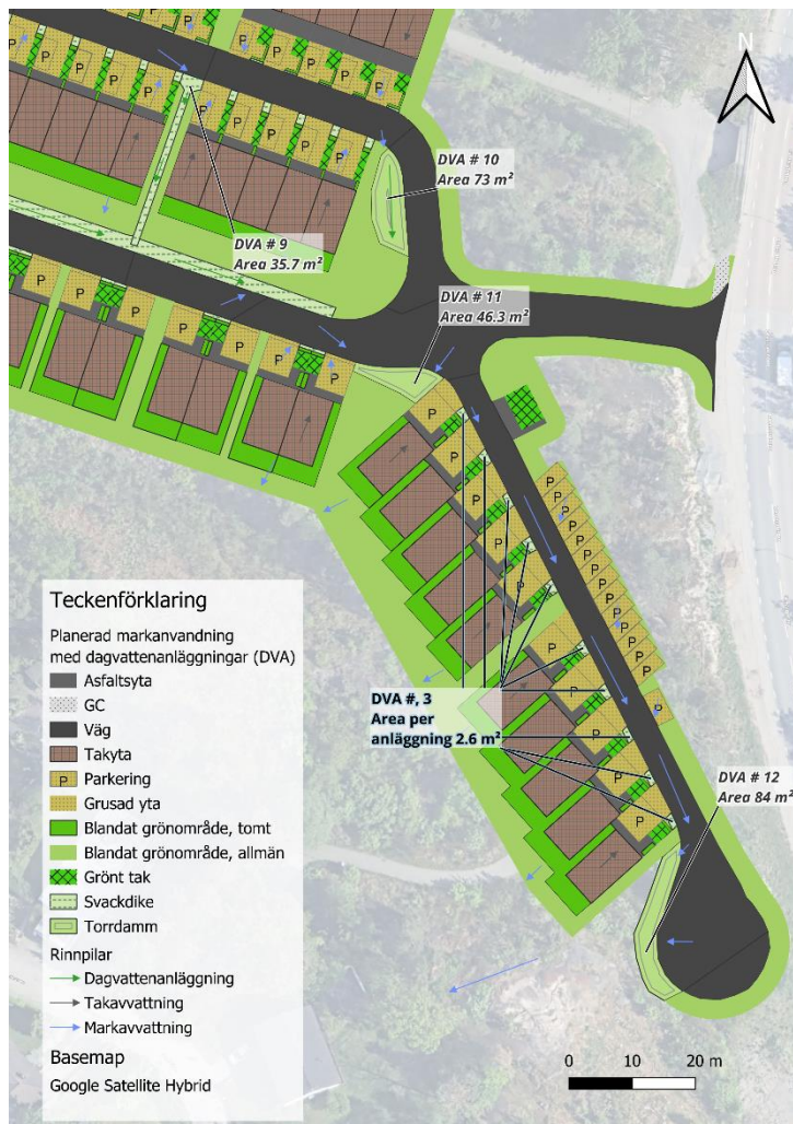
Figur 10. Föreslagen dagvattenhantering för den sydöstra delen av planområdet.
