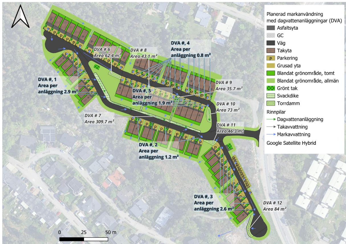
Figur 7. Övergripande illustration över föreslagen systemlösning för dagvattenhantering tillsammans med beräknat ytbehov per dagvattenanläggning (DVA).
