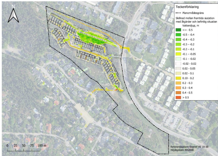
Figur 13. Skilnad i maximalt vattendjup vid 100-årsregn och klimatafaktor 1,3 mellan framtida situation med åtgärder och befintlig situation. Gröna ytor visar minskat vattendjup och gul-röda ytor visar ökat vattendjup.
