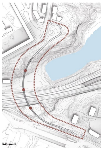
Figur 53. Röda markeringar visar studerad bröstödsplacering (bropelare) för västligt alternativets huvudspann. (Ramboll 2026)
