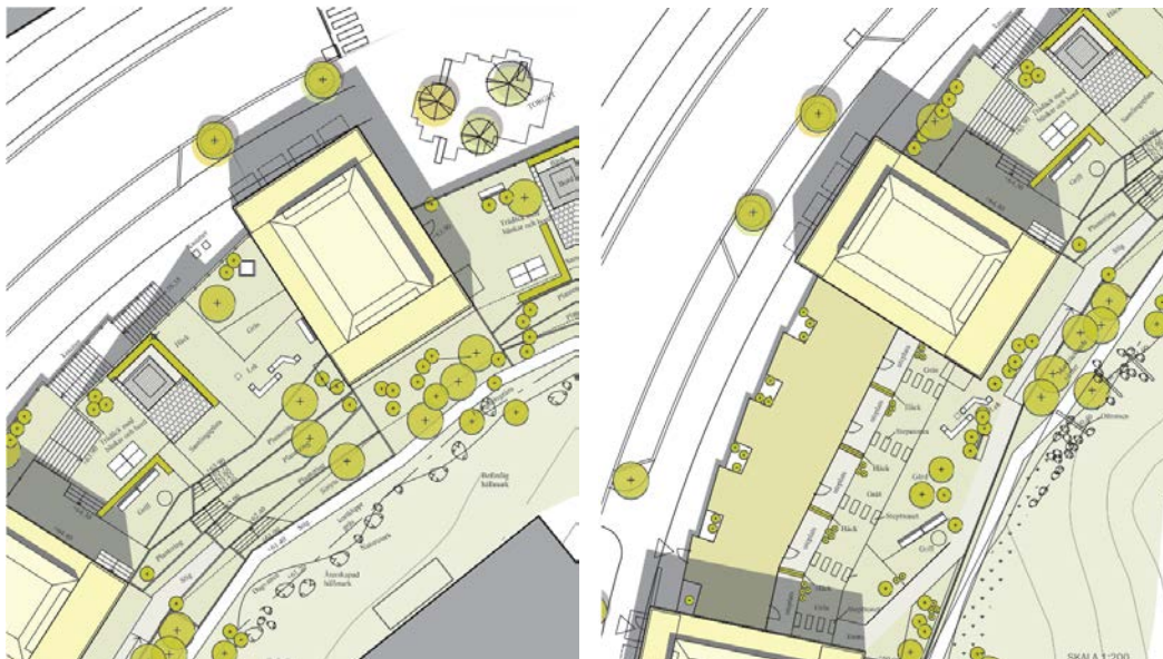
Situationsplan som visar idéerna om terrassering och gångstråk mellan de nya bostadsgårdarna och grannfastigheten. Den vänstra bilden är mellan hus 2 och 3 och den högra bilden mellan hus 3 och 4. Illustration: Liljewall arkitekter.
