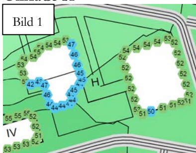
Ekvivalent ljudnivå vid fasad, högsta nivå vid någon våning, samt markering av ljuddämpad sida. Bild: Structor
