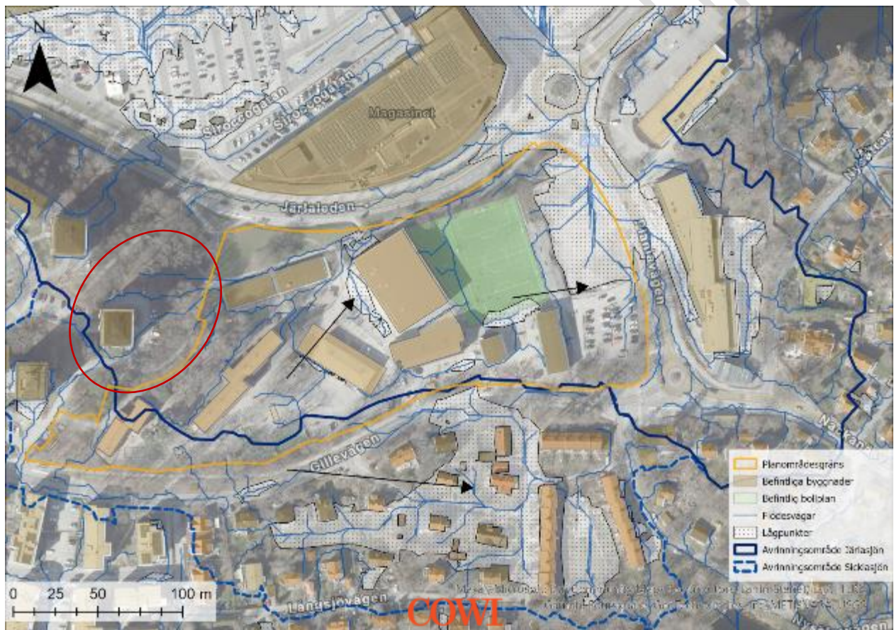
Figur 10. Karta över planområdet samt vattendelare för aktuella avrinningsområden av befintlig situation. I kartan visas även flödesvägar (ljusblå), generella flödesriktningar (svarta pilar) samt lågpunkter (prickat). Röd ring markerar flöden från uppströmsliggande bostadsområde.
