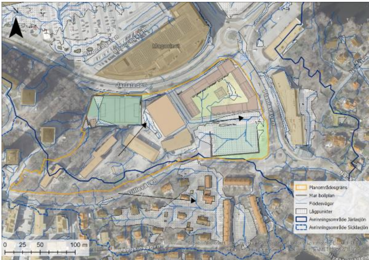
Figur 17. Karta över planområdet samt vattendelare för aktuella avrinningsområden. I kartan visas även flödesvägar (ljusblå), generella flödesriktningar (svarta pilar) samt lågpunkter (prickat).
