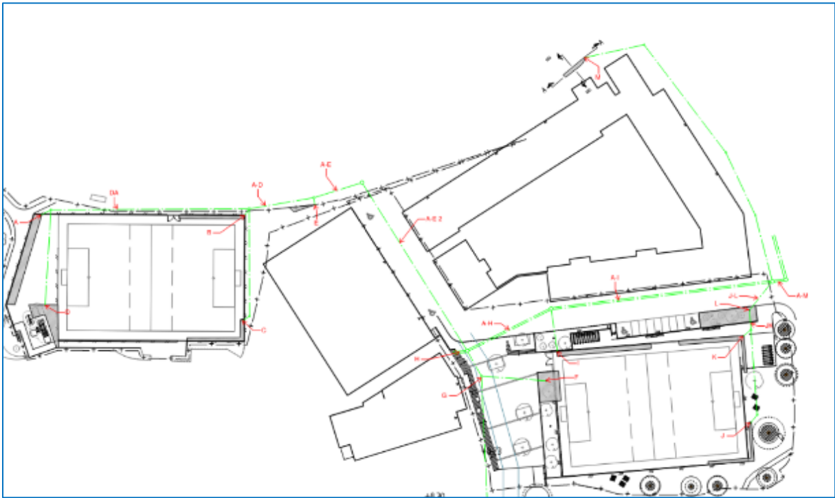
Figur 25. Namngivna sträckor för dimensionering av dagvattenledningar
