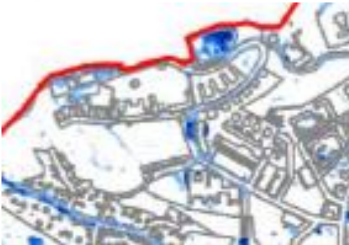
Figur 5 Översvämningsdjup och utbredning vid 100-årsregn. Figuren är ett urklipp ur översvämningskartan för hela Västra Sicklaön, som redovisas i DHIs rapport.
