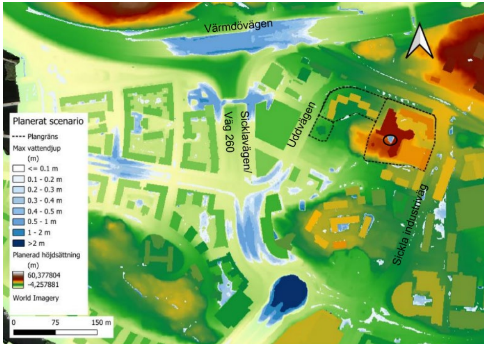
Figur 45. Maximalt vattendjup för planerat scenario för ett klimatanpassat 100-årsregn med klimatfaktor 1,25 med en total volym på 81 millimeter. Ansamling av vatten sker i en lokal lågpunkt (se svart ring) vilket beror på ett fel i höjdmodellen. Marken på denna plats kommer inte att förändras, vilket innebär att vatten inte kommer att ansamlas vid byggnaden. (Sweco, 2025)
