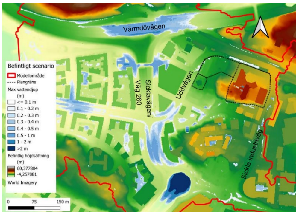
Figur 44. Maximalt vattendjup för befintligt scenario för ett klimatanpassat 100-årsregn med klimatfaktor 1,25 med en total volym på 81 millimeter. (Sweco, 2025)
