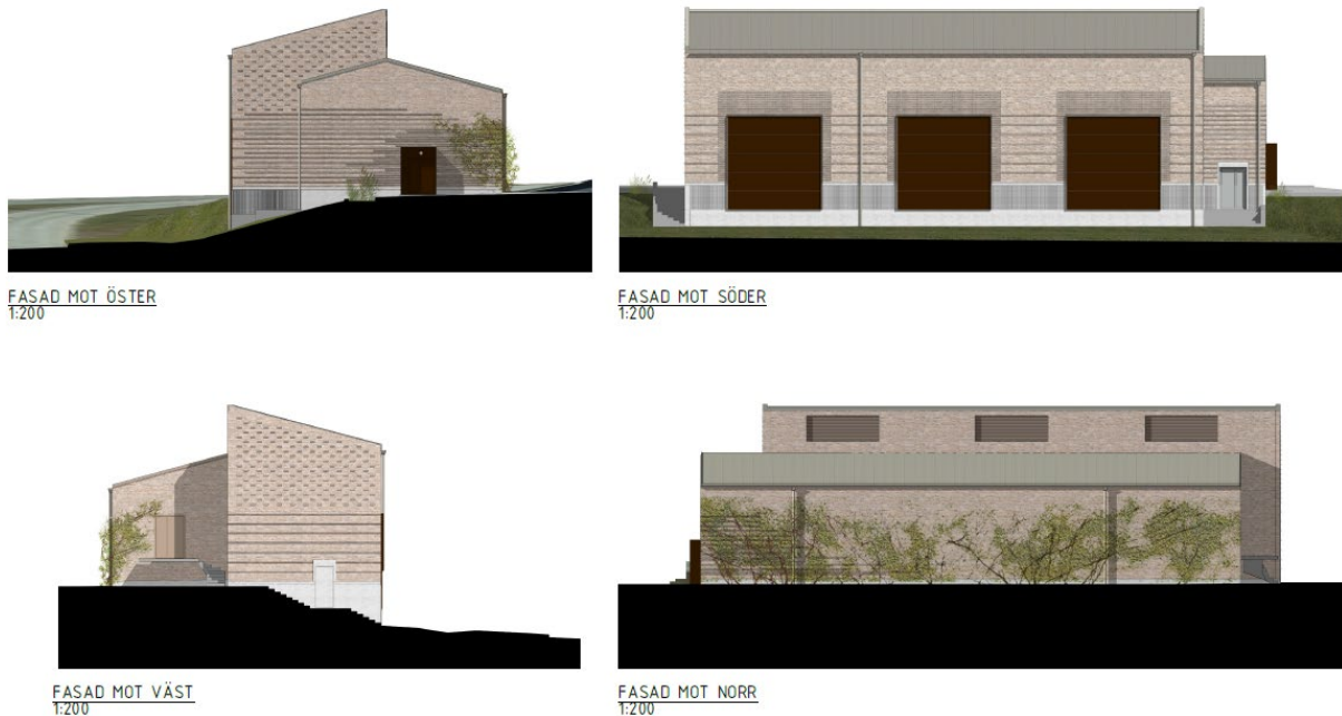
Figur 14: Fasadritningar för fördelningsstationen som föreslås i detaljplanen. Byggnaden uppförs i tegel. Bilderna är inte skalenliga (Urban Design 2026).
